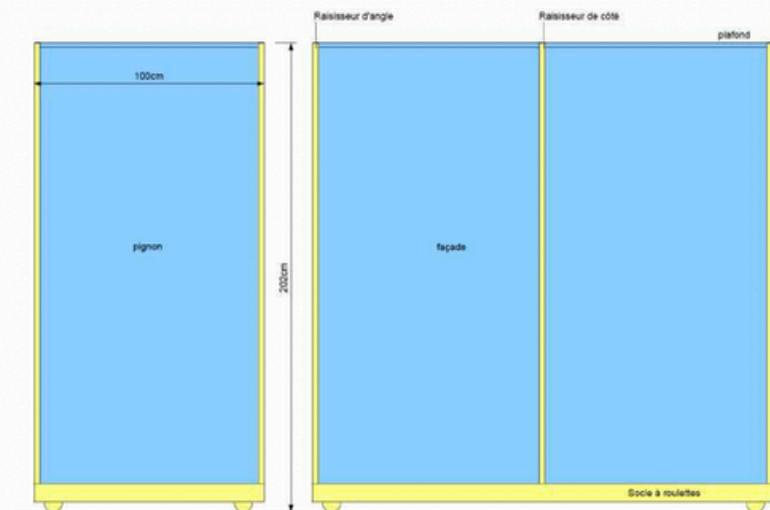
Cette galerie est entièrement démontable. Les parois sont modulables, elles peuvent être en bois ou en polycarbonates. La surface d'accrochage est ainsi variable. La galerie est fermée, le public ne rentre pas à l'intérieur. La surface extérieure peut être utilisée comme support de communication. Elle peut restée sans surveillance dans un établissement. Cette galerie est sur roue avec des freins.
